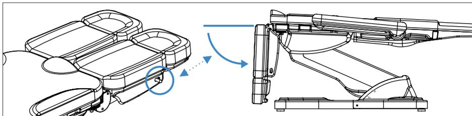
Naciśnij dźwignię, aby dostosować kąt nachylenia nóg.
