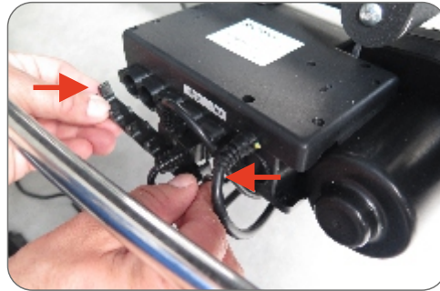
5. Załóż blokadę wtyczek silnika.
