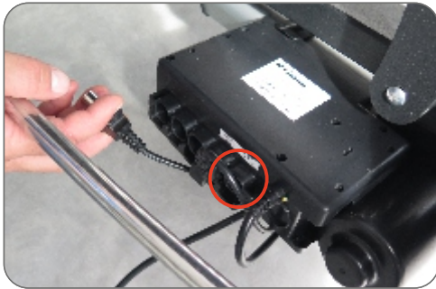
2. Wypnij wtyczkę zasilania ramy sterującej (HC)
