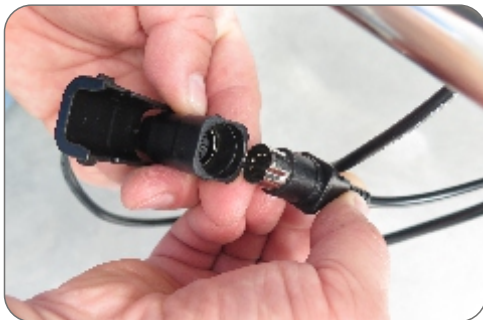
4. Podłącz wtyczkę pilota (2) do wypiętego przewodu ramy sterującej.
